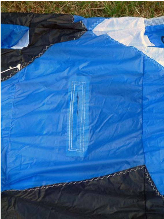
Überdruckventile unterhalb der Anströmkante.
